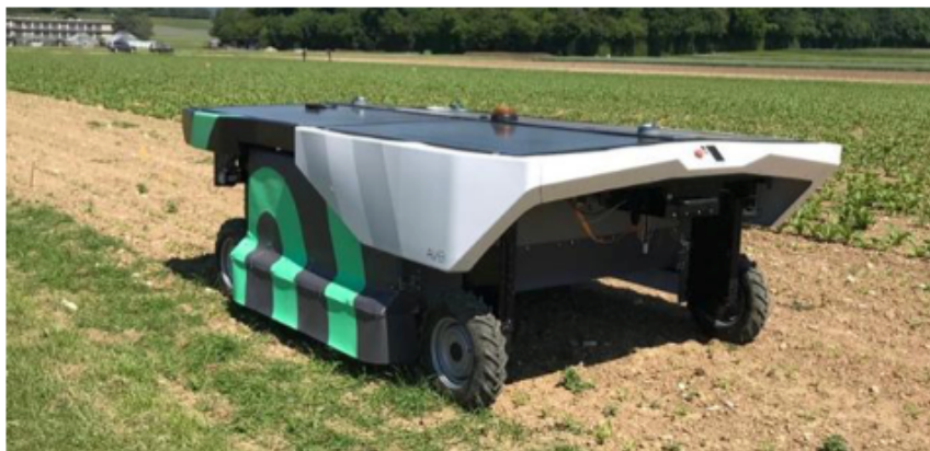
Robot autónomo accionado por energía solar desarrollado por Ecorobotix (Francia).
