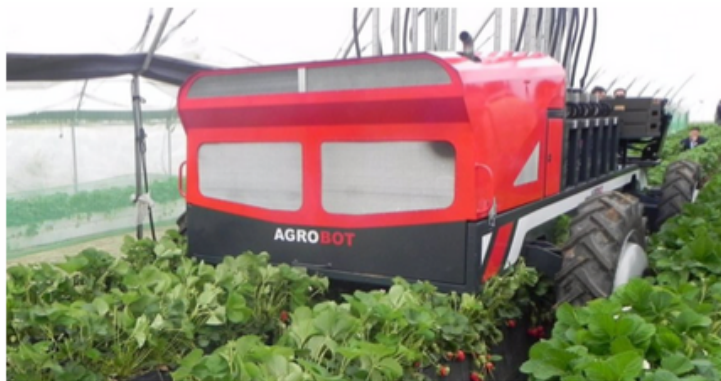
Robot para recolección de fresas desarrollado por Soluciones Robóticas Agrícolas S.L. (España).
