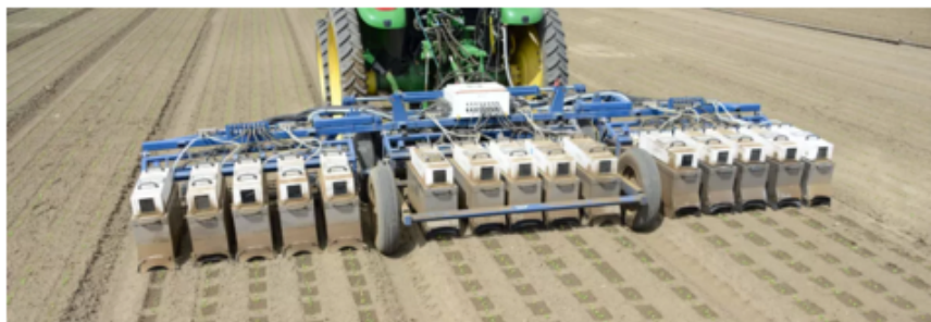
Robot para aplicación de fitosanitarios desarrollado por Blue River Technology (USA).
