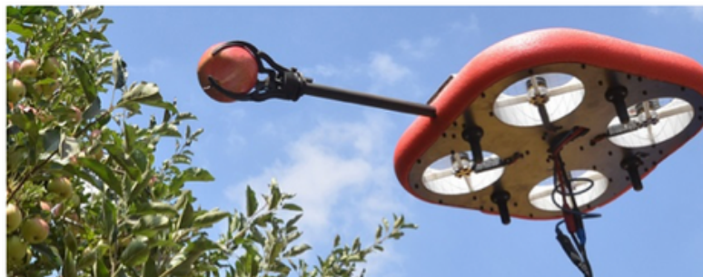
Prototipo de dron desarrollado por Tevel Aerobotics Technologies para la recolección de frutas.
